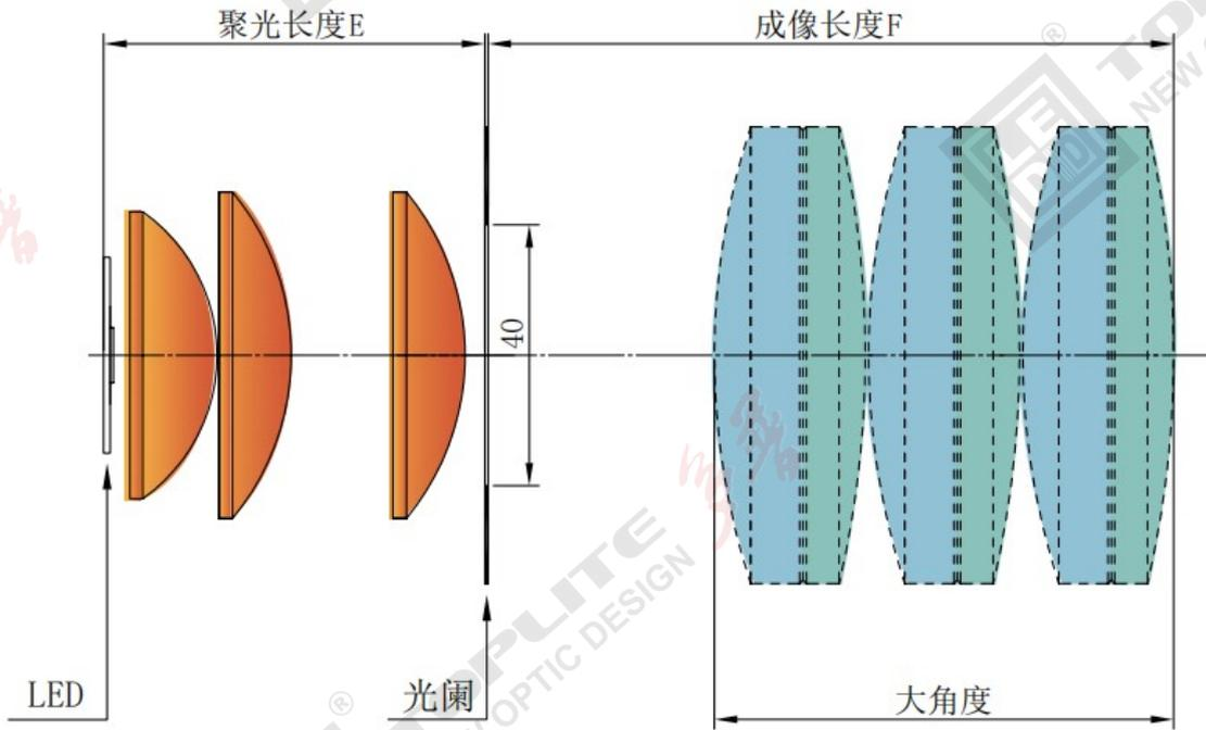
如上图所示，一个典型的成像系统光路图从左到右分别为 LED 光源（COB）、聚光透镜组、光阑和成像透镜组。聚光透镜组为 3 片平凸透镜组组成，光阑尺寸为  $\Phi 40\text{mm}$ ，成像透镜组由 2 个或 3 个胶合透镜组成。如果是 2 个胶合透镜的，通过移动两个胶合透镜改变其间距可以实现线性变焦。如果是 3 个胶合透镜的，左边两个 A 和 B 算一组，右边 C 算另一组，移动这两组，改变两组的间距来实现线性变焦。光路长度请参考具体的每款角度的光路图。
